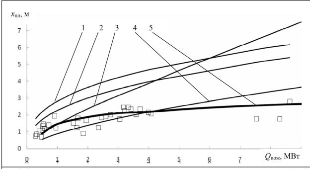
Рис. 2. Зависимость высоты пламенной зоны от мощности тепловыделения в очаге горения: 1 - yp. (5); 2 - yp. (6);  $3 - \gamma = 0$ ;  $4 - \gamma = 10$  град.; 5 - предложенная методика;  $\square$  - эксперимент [1]
