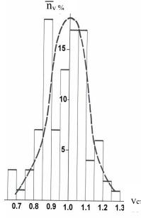
Рис.2. Распределение скоростей в выходном сечении сборки (  $\overline{n}_V = n_V/N$ , N — общее число стержней в сборке,  $\overline{n}_V$  - число стержней, для которых скорости обтекания одинаковы,  $V_{\text{ст}}$  - скорость обтекания единичного стержня,  $\overline{V}$  - средняя скорость газа для сборки стержней)
