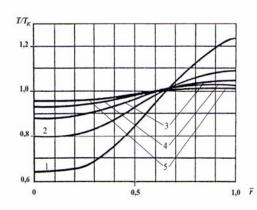
Рис. 1. Изменение безразмерной температуры газа по радиусу в выходном сечении ТВС.(  $\overline{D}_{3}$  = 0,005 – кривая 1;  $\overline{D}_{3}$  = 0,02 – кривая 2;  $\overline{D}_{3}$  = 0,035 – кривая 3;  $\overline{D}_{3}$  = 0,05 – кривая 4;  $\overline{D}_{3}$  = 0,065 – кривая 5).
