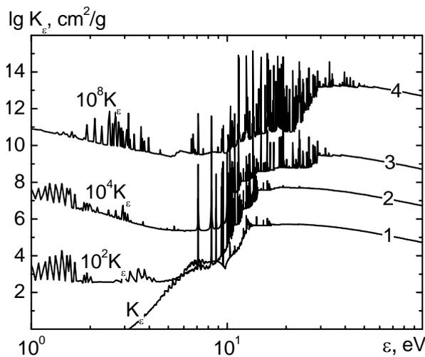
Fig. 1 Spectral absorption coefficients of air plasma at  $P=1$  atm. 1–  $T=5 \times 10^3$  K; 2– $10^4$ ; 3–  $2 \times 10^4$ ; 4–  $3.16$  eV
