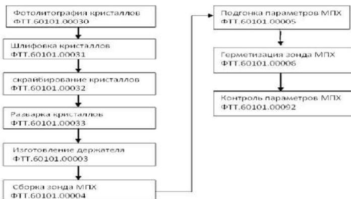
Рис. 4. Технологический процесс изготовления МПХ
