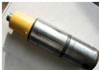
Рис. 8. Датчик загрузки самосвала
