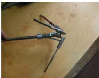
Рис.1. Сенсор магнитного поля для космических аппаратов
